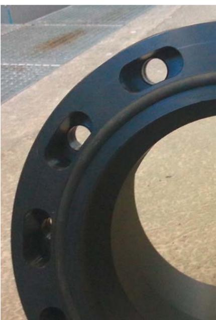
Langlöcher ermöglichen ein Drehen des Flansches während der Anbindung an die Armatur und erleichtern die Ausrichtung auf der Baustelle
