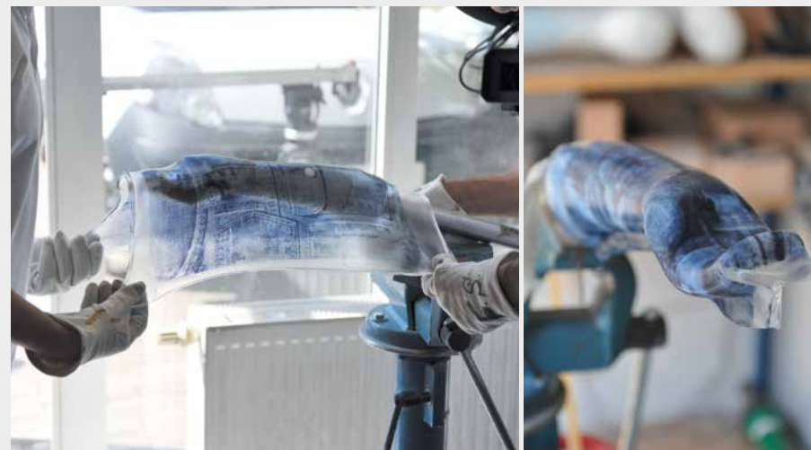
Tvarování za tepla u termopapírem obarvené PE-HWV desky SIMONA®SIMOLIFE přes sádrový model předloktí.
