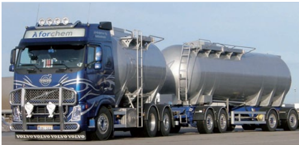
Autocisterna o objemu 18, resp. 31 m 3 z materiálu 2,3 mm SIMONA® E-CTFE-AK v kombinaci s dvojitou sklolaminátovou konstrukcí
