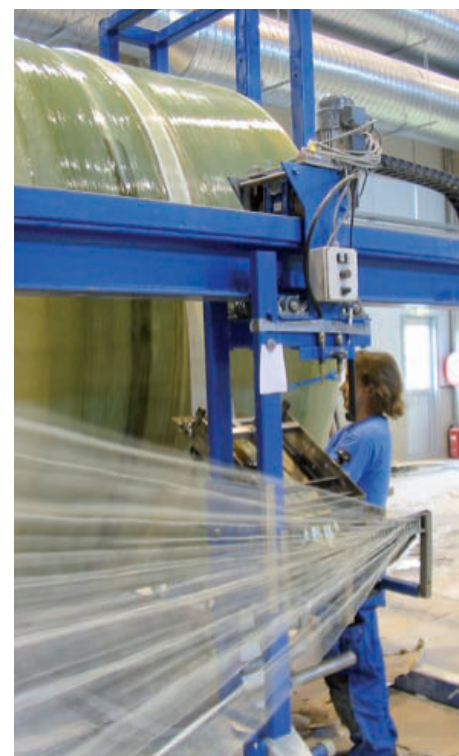
Nanášení sklolaminátové struktury přes filamentové ovinutí na podkladový tenkostěnný materiál SIMONA® E-CTFE-AK
