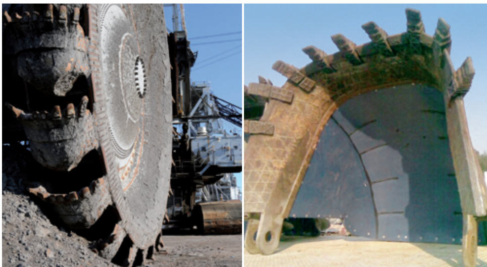
Vyložení lžíc rypadla pro povrchové dobývání uhlí v Austrálii materiálem dehoplast® superlining
